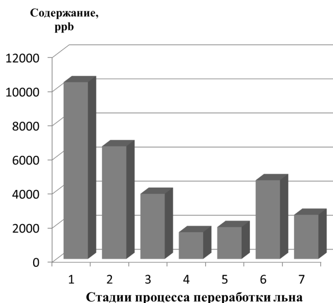
Рисунок. 3.2. Общее содержание идентифицированных органических соединений во льне на стадиях его переработки: 1 – чесаный лён; 2 – эмульсированный лён; 3 – суровая ровница; 4 – отбеленная ровница; 5 – пряжа; 6 – ошлихтованная пряжа; 7 – суровая ткань
