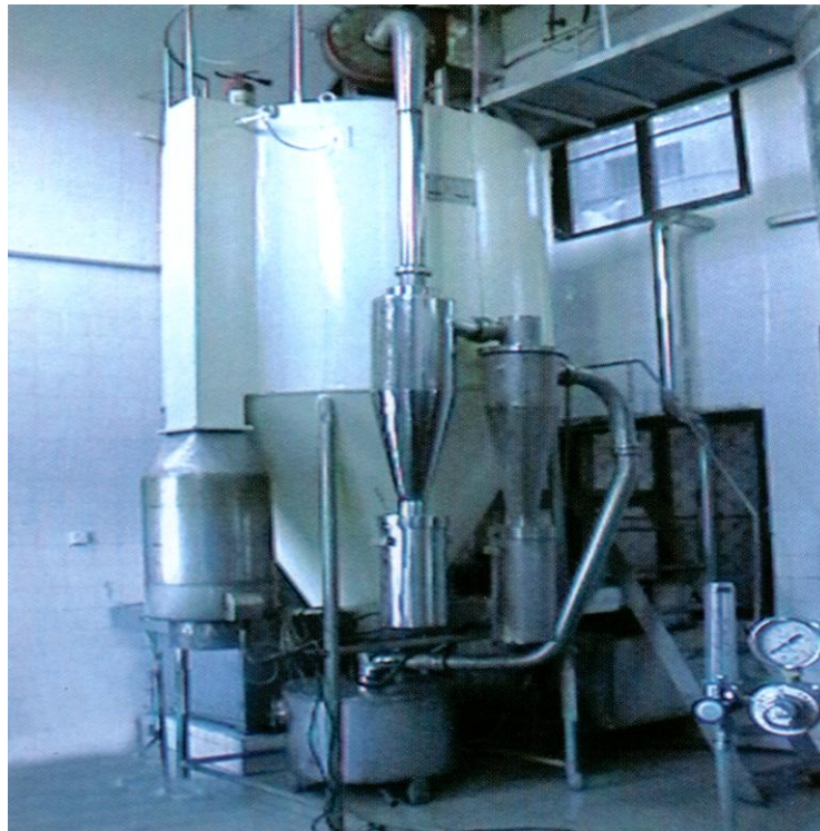
Рисунок 3.6. Вид установки для экстракции сжиженным \text{CO}_2 (НПП «Тангрис»)
